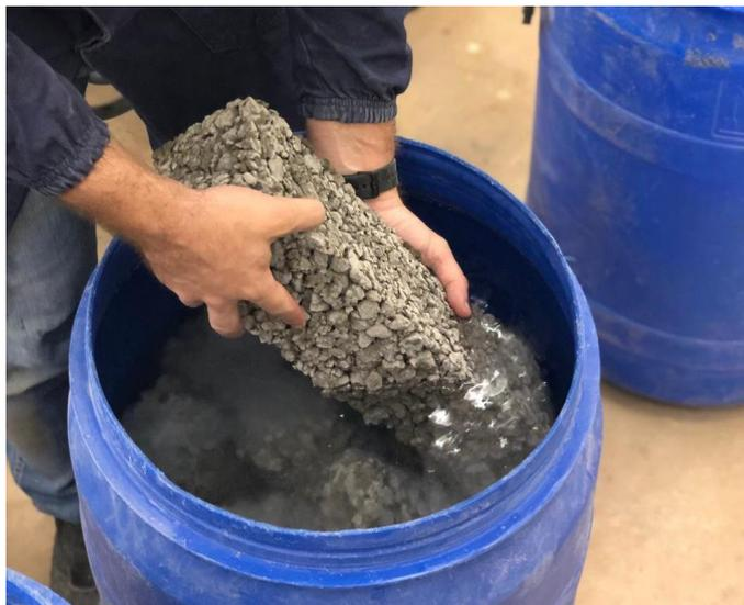
Figura 8 - Colocação dos corpos de prova em tambor com água por 28 dias
