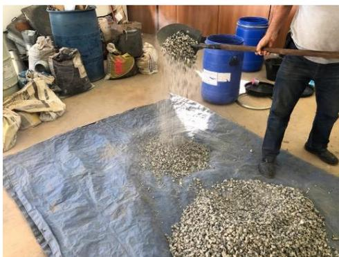
Figura 5 - Processo de mistura do agregado que estava segregado antes dos ensaios
