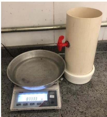
Figura 10 - Medidor de volume e balança
