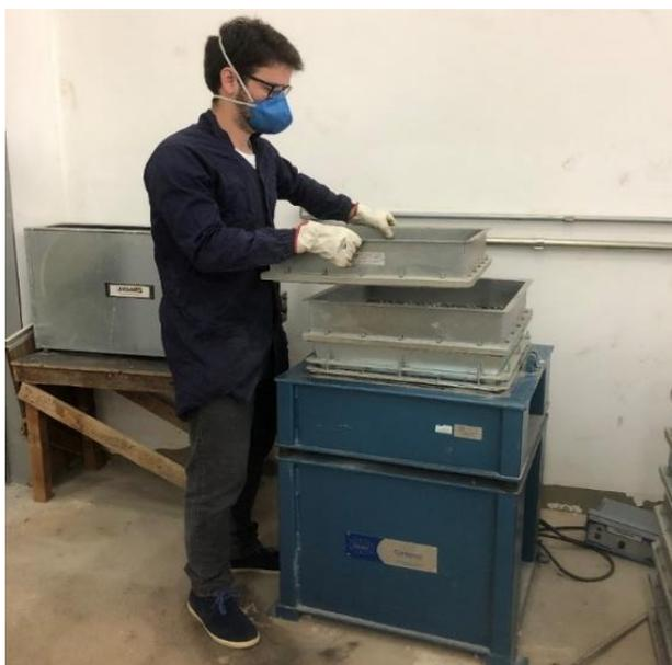
Figura 3 - Processo de peneiramento dos agregados entre as peneiras 3,35 e 19,00 mm
