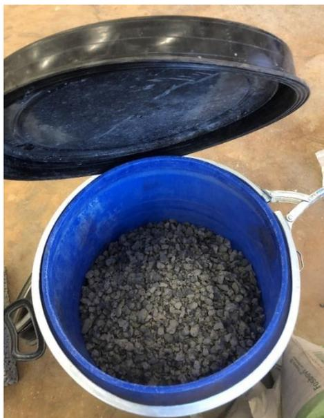
Figura 4 - Armazenagem dos agregados em tambor plástico
