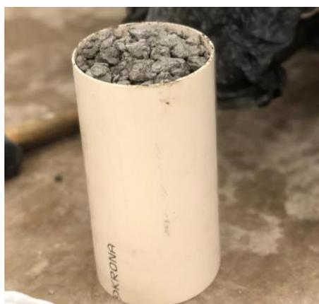
Figura 11 - Corpo de prova utilizado no ensaio de permeabilidade e percentual de vazios
