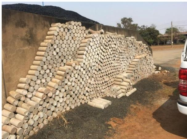
Figura 1 - Depósito de corpos de prova em construtora de Rio Verde – GO
